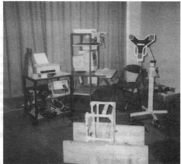
図2. 三次元動作解析装置と下肢固定台（手前）
